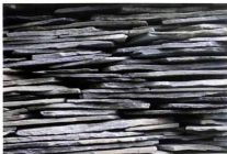
A sinistra: borgate Baudinet con alle spalle il massiccio della Mirauda Sopra: particolare delle lerce utilizzate per la copertura dei tetti
